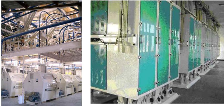
**Figura 2.11.** Conjunto de molinos de rodillos (izq.) y sección de Planchister de una harinera (der.)
