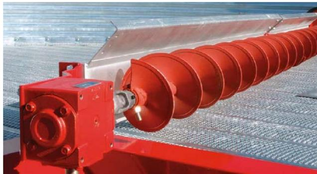
**Figura 1.12.** Sección e imagen de un transportador de tornillo sin fin (GSI Grain Systems, 2009).
