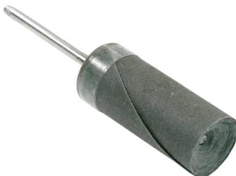
Pour travailler l'intérieur et l'extérieur des bagues et toutes autres pièces plates de bijouterie en fonte. Une fois que le cône est usé, enlever la coque supérieure du cône pour en obtenir une neuve. Peuvent être utilisés jusqu'à diamètre d'environ 6mm. Montés sur une tige standard de 2,35 mm.
