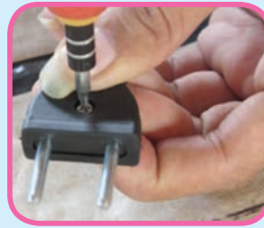
Sumber: Dokumen Kemdikbud Gambar 3.38 Pemasangan colokan jantan
