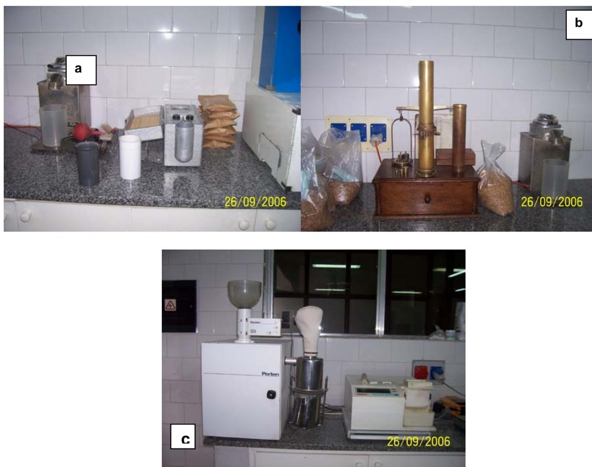
**Figura 21. a) Determinador de humedad; b) Balanza Schopper para determinación de peso hectolítrico; c) Molino Perten y determinador de porcentaje de proteína, NIR.**
