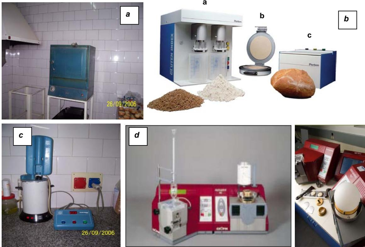
**Figura 22. Instrumental de laboratorio de calidad: a) Mufla para cenizas; b) Glutomatic, determinación del porcentaje de gluten húmedo (a- preparación de masa y lavado del gluten; b- plancha para secar gluten; c- centrífuga); c) Determinación de la actividad de la alfa-amilasa (número de caída, Falling Number) según HAGBERG –PERTEN. d) Alveógrafo Chopin.**
