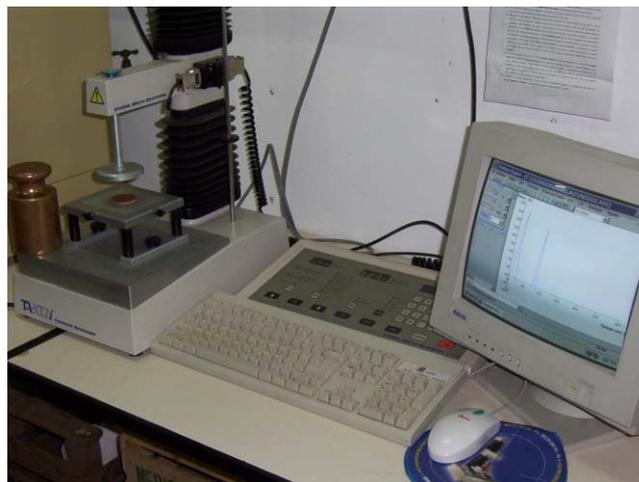
Figura 2. Equipo TA.XT2i Texture Analyzer (STABLE MICRO SYSTEMS, Surrey, U.K.)
