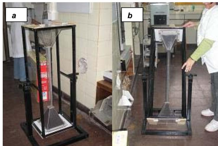
Figura 5. a) Medidor de volumen de pan por desplazamiento de semillas de colza, b) Midiendo volumen de pan.
