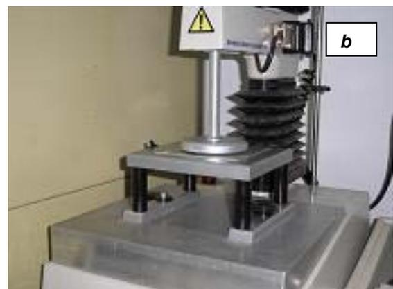
Figura 3. a) disco de masa antes de la compresión; b) durante la compresión
