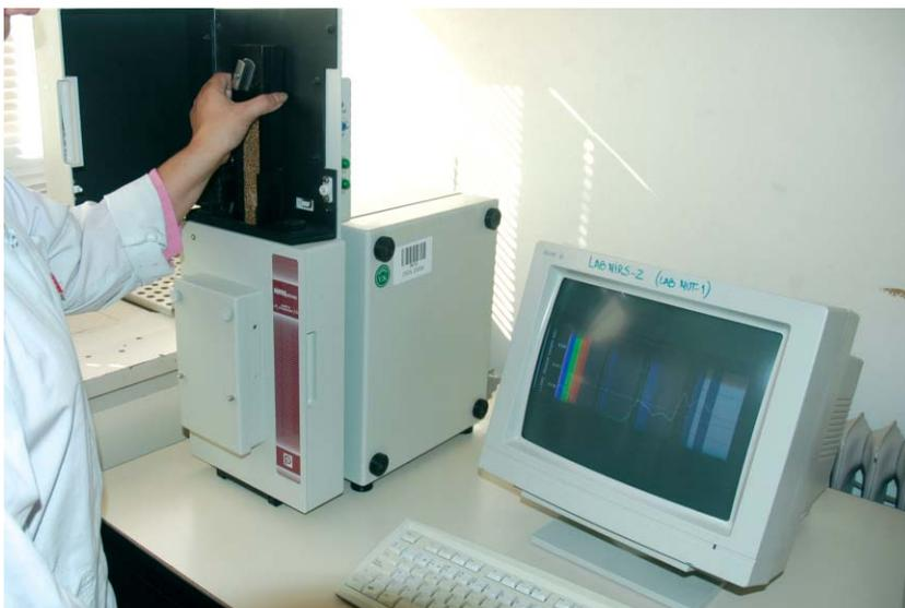
**Figura 4.19.** Espectrofotómetro de infrarrojo cercano NIRSystems 6500 (Foss NIRSystems Inc, Denmark)
