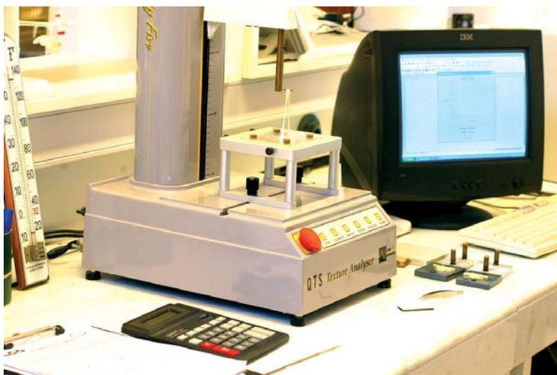
**Figura 4.18.** Ensayo de microextensibilidad utilizando un texturómetro CNS Farnell QTS-25 (Brookfield Engineering Laboratories Inc, USA).
