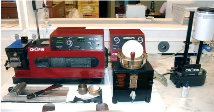
**Figura 4.15.** Alveógrafo (Chopin Technologies, Tripette et Renaud, Francia).
