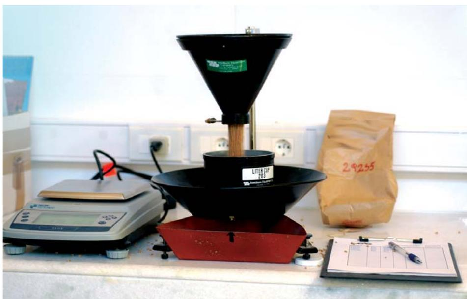
Figura 4.1. Equipo de determinación de peso hectolítrico (Seedbuero Equipment Co, USA).
