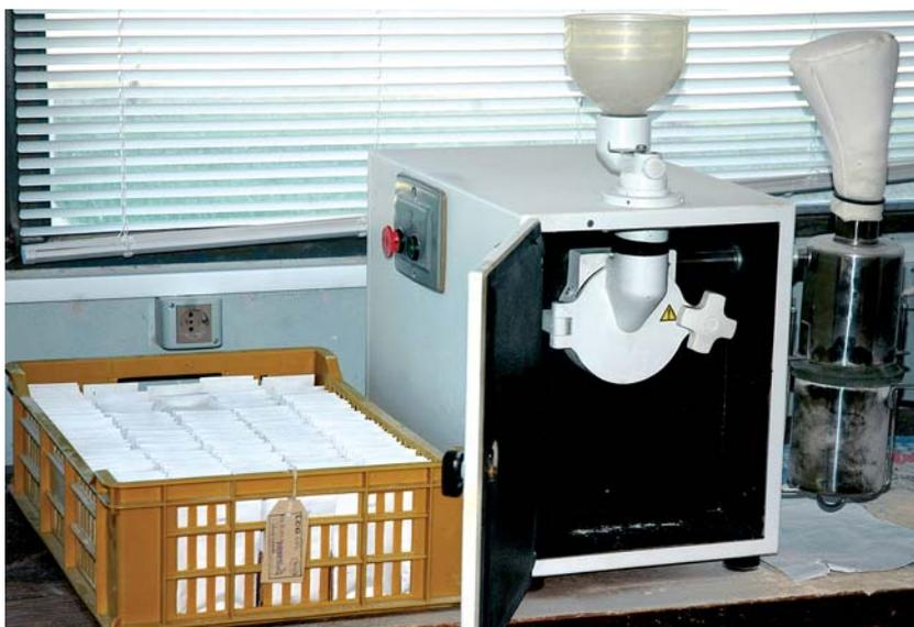
Figura 4.2. Molino de molienda integral, Perten 3100 (Perten Instruments AB, Suecia).
