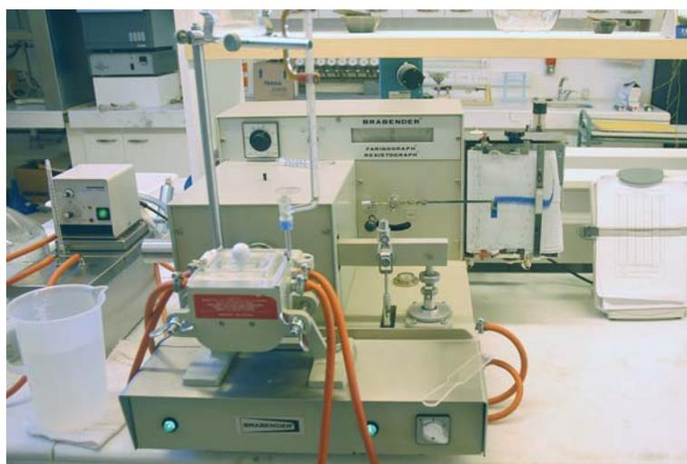
Figura 4.11. Farinógrafo (Brabender GmbH & Co KG, Alemania).
