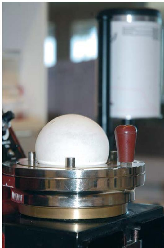
**Foto 4.16.** Burbuja de masa formada con un alveógrafo.
