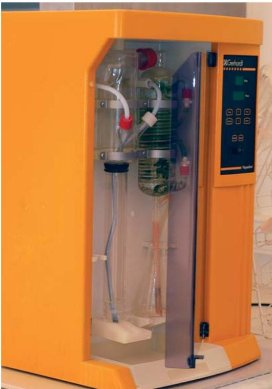
**Figura 4.4.** Destilador semiautomático para Kjeldahl Vapodest 20 (Gerhardt Laboratory Systems, Alemania).
