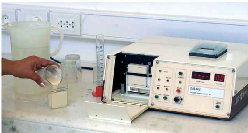
**Figura 4.10.** Determinador de color Satake Colour Grader IV (Satake USA Inc, USA).
