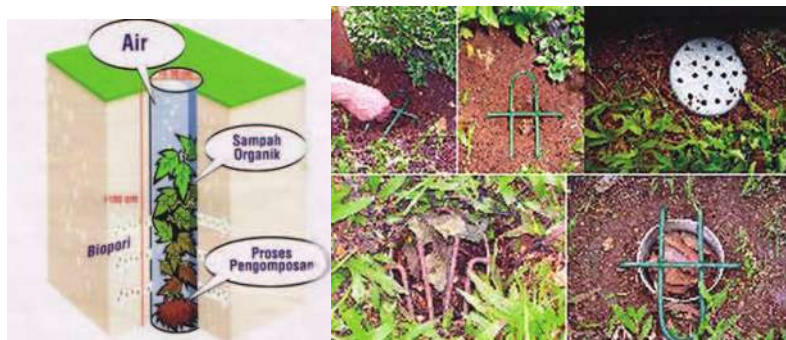
Gambar 9.14 Teknologi Biopori untuk Penampungan Air Hujan serta Pemanfaatannya untuk Pembuatan Kompos
