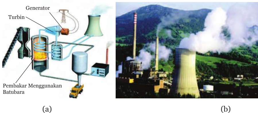
Gambar 9.26 (a) Skema dan (b) Foto Pembangkit Listrik Tenaga Uap dengan Tenaga Batubara
