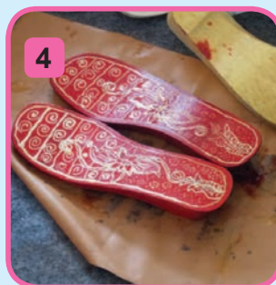
Hasil pencelupan, dikeringkan dahulu. Bila perlu, pencelupan dapat diulang agar mendapatkan warna yang tebal.
