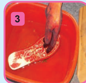
Mencelup warna dengan naphthol.
