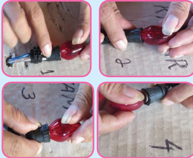
Gambar 2.23 Pemasangan lampu lombok.
