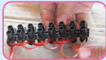
Gambar 2.20 Proses pembuatan terminal pembagian arus listrik.
