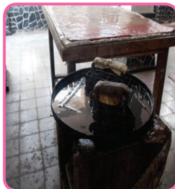
Meja dan wajan (krengseng) serta kompor untuk canting cap
