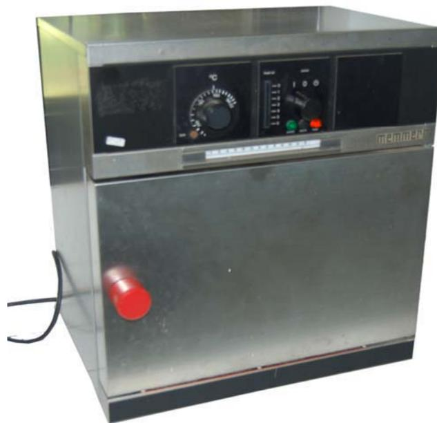
Gambar 6.8. Alat pengukur kadar air
