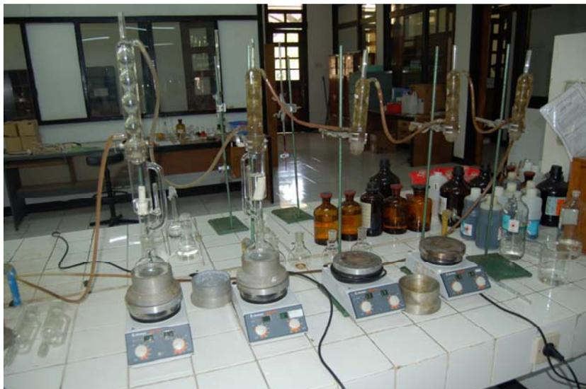
Gambar 6.10. Peralatan pengukuran kadar lemak
