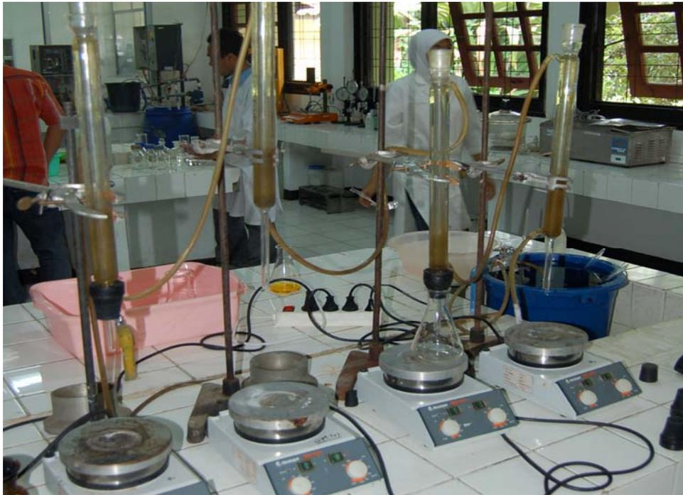
Gambar 6.11. Peralatan pengukuran kadar serat kasar
