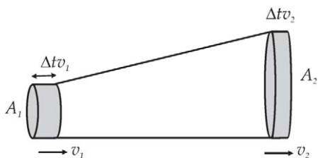
Gambar 7.22 Fluida mengalir melalui pipa masuk dari luasan A_1 keluar di ujung satunya yang luasnya A_2 . Daerah yang berbayang-bayang memiliki volume yang sama.
