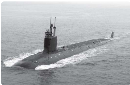
Gambar 7.11 Kapal selam mempunyai tangki untuk mengisi atau membuang air untuk merubah kerapatan kapal.
