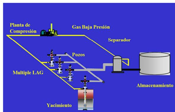
Figura 2.4 -Esquema de producción.
