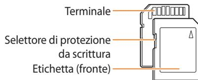
Potete impedire l'eliminazione dei file utilizzando il selettore di protezione da scrittura presente sulle schede SD, SDHC, o SDXC. Fate scorrere il selettore verso il basso per bloccare o verso l'alto per sbloccare. Sbloccate la scheda quando scattate foto o registrate video.
