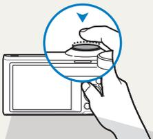
Premete a metà [**Otturatore**] e regolate la messa a fuoco. La fotocamera regola automaticamente messa a fuoco ed esposizione.
