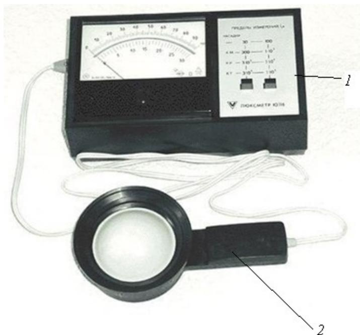
*1 – измеритель; 2 – фотоэлемент и насадка К со сферической матовой поверхностью (насадки Р, Т, М не показаны)*
