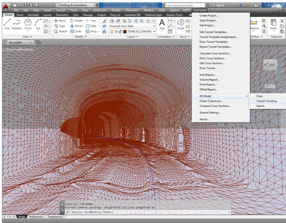
El modelo 3D resultante se puede exportar a distintos formatos de ficheros de definición geométrica, como son OBJ y OFF. Esto permite la visualización del modelo en aplicaciones como 3DS Max, Meshlab, etc.
