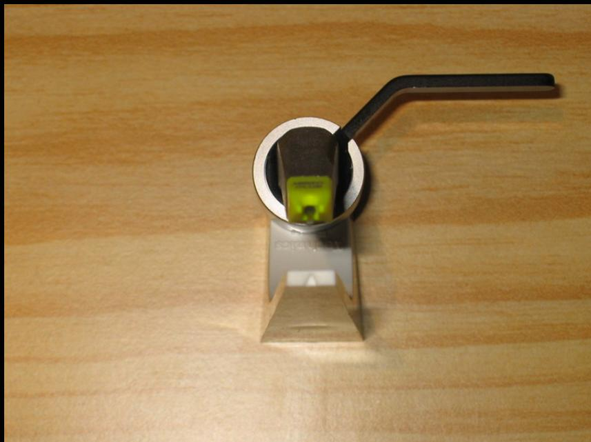
Figura 10: Ajuste transversal "de serie" en cápsulas tipo Concorde
