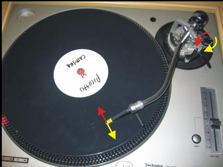
Figura 18: Regulación del AntiSkating
