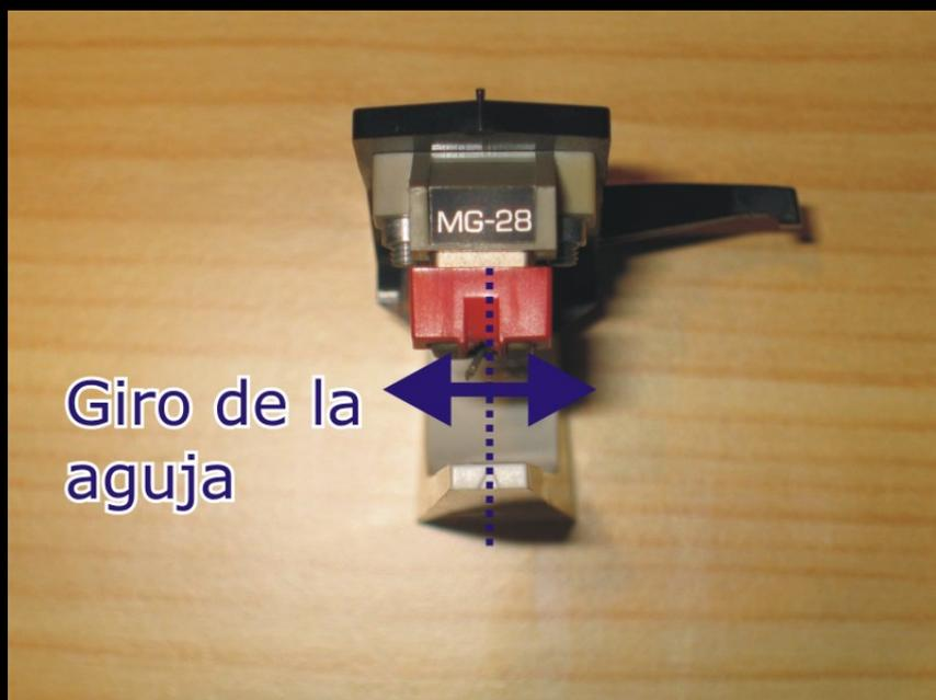
Figura 8: Ajuste transversal de la cápsula
