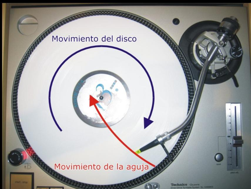
Figura 16: Movimientos del disco y la aguja durante la reproducción normal de un vinilo
