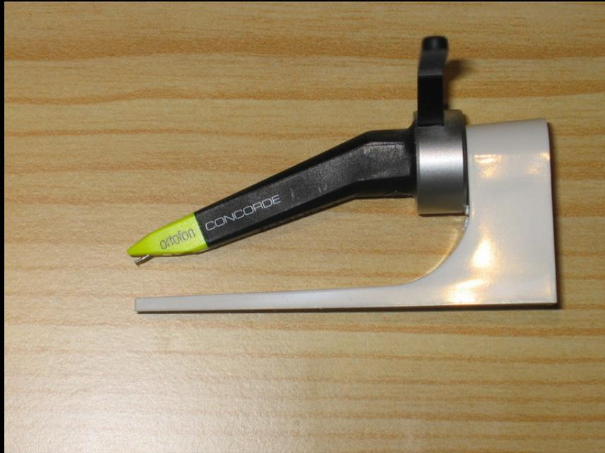
Figura 9: Ajuste longitudinal "de serie" en cápsulas tipo Concorde
