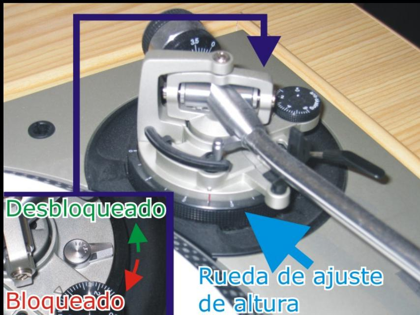
Figura 3: Rueda de ajuste de altura del brazo
